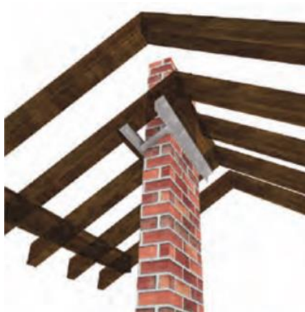
Fotografija 18. Prikaz lokalnog pridržanja dimnjaka za krovnu konstrukciju
