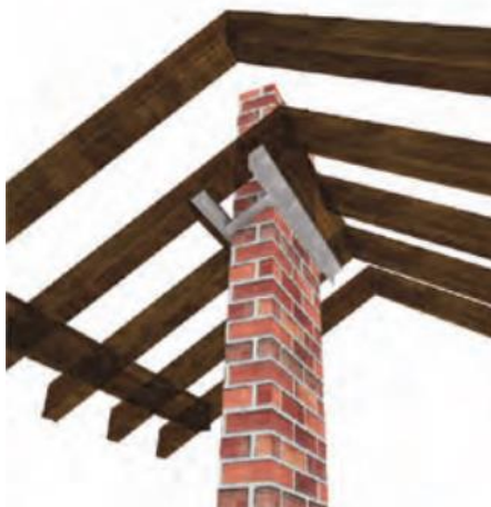
Slika: Lokalno pridržanje dimnjaka za krovnu konstrukciju
